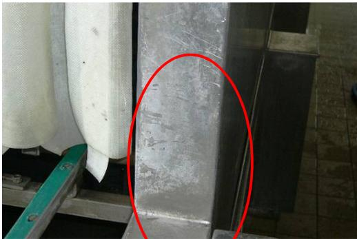
Le carbonate de calcium s'est déposé sur une surface chromée en formant le tartre.
