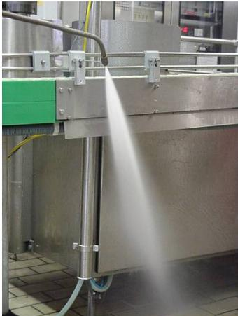
L'emploi d'appareils à haute pression pour un nettoyage de surface n'est pas adéquat dans un local de fabrication. Dans le brouillard (aérosol) inévitable qui accompagne le jet, de fines particules chargées de bactéries se répandent dans tout l'espace ambiant et entraînent une contamination des produits. C'est pour cette raison qu'il faut effectuer le nettoyage à haute pression dans un local séparé.
