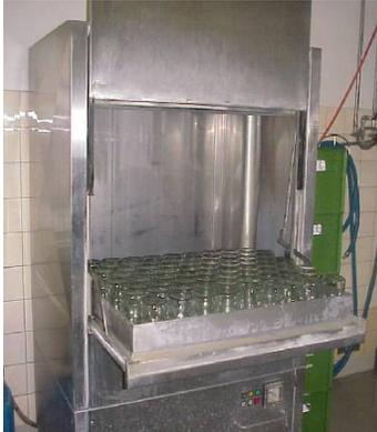
En général, les installations sont équipées de pompes doseuses commandées par conductivité. Il faut adapter le dosage à la dureté de l'eau.
