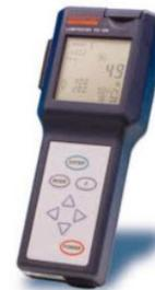
Appareil de mesure de l'ATP
