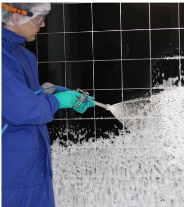
Le nettoyage à la mousse se prête pratiquement à tous les types de salissures, il est surtout utilisé pour le nettoyage de grandes surfaces. Le facteur mécanique est en partie remplacé par le facteur temps. En cas de salissures importantes, on recommande toutefois de broser la surface. Selon le type de salissure, on utilise des produits de nettoyage neutres, alcalins ou acides.
